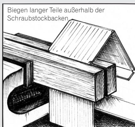
Lange Bauteile, die mehrfach gebogen werden, biegen wir außerhalb der Schraubstockbacken. Dazu nehmen wir die ca. 15 cm langen Biegehölzer zum Einspannen neben den Schraubstockbacken. Vor jedem Biegevorgang neu ausrichten!
