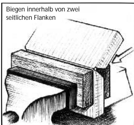
Oft müssen Bauteile an mehreren Flanken gebogen werden. Sind beide Längsflanken gebogen, nehmen wir ein Biegehölz von entsprechender Länge, welches zwischen die bereits gebogenen Flanken passt und biegen diese an dem innen liegenden Holz vorbei.
