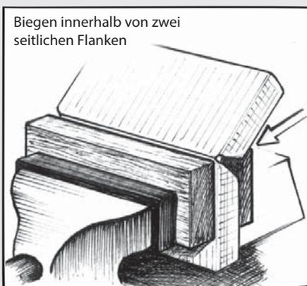
Oft müssen Bauteile an mehreren Flanken gebogen werden. Sind beide Längsflanken gebogen, nehmen wir ein Biegeholz von entsprechender Länge, welches zwischen die bereits gebogenen Flanken passt und biegen diese an dem innen liegenden Holz vorbei.
