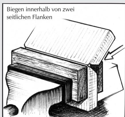
Oft müssen Bauteile an mehreren Flanken gebogen werden. Sind beide Längsflanken gebogen, nehmen wir ein Biegehölz von entsprechender Länge, welches zwischen die bereits gebogenen Flanken passt und biegt diese an dem innen liegenden Holz vorbei.
