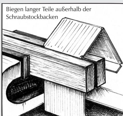
Lange Bauteile, die mehrfach gebogen werden, biegen wir außerhalb der Schraubstockbacken. Dazu nehmen wir die ca. 20 cm langen Biegehölzer zum Einspannen neben den Schraubstockbacken. Vor jedem Biegevorgang neu ausrichten!
