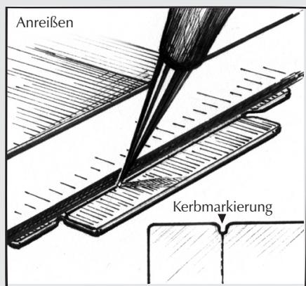
Die zu biegenden Bauteile mit der unbedruckten Seite nach oben auf eine ebene, saubere Unterlage aus Pappe legen. Das Stahllineal wird genau mittig an den Kerbmarkierungen angelegt. Mit der Reißnadel anreißen.
