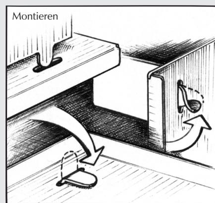
Sind alle Bauteile gebogen, werden die Blechlaschen in die dafür vorgesehenen Schlitze gesteckt und verlappt. Man kann die Laschen umbiegen oder mittels einer kleinen Flachzange um 90° verdrehen (z. B. an freistehenden Teilen).
