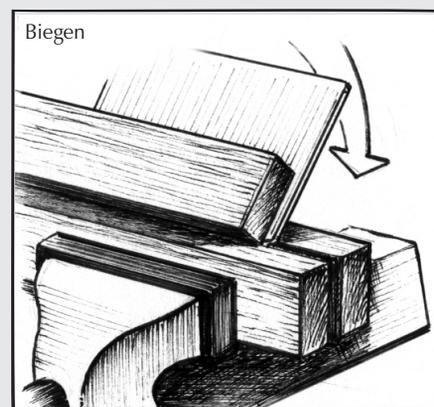
Biegehölzer mit dazwischen liegendem Bauteil in den Schraubstock spannen. Vor dem Biegen nochmals ganz genau ausrichten! Ein drittes Biegehölz an der Biegekante anlegen und mit leichtem Druck das Blech umbiegen.
