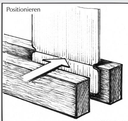
Vor jedem Biegevorgang je zwei Biegehölzer genau parallel mittig zwischen den Kerben positionieren und zusammendrücken. Gegebenenfalls mit kleinen Klebebandstreifen fixieren.
